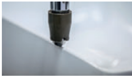
À L'INSTITUT DE CÉRAMIQUE DE MEISSEN, LA CÉRAMIQUE SAPHIRKERAMIK À PAROIS MINCES A ÉTÉ TESTÉE PAR RAPPORT À SON ÉNERGIE DE CHOC
